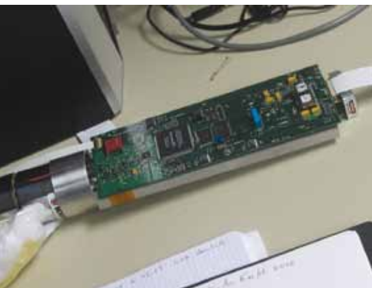
Vue des composantes internes du GMON : détecteur gamma, photomultiplicateur, carte électronique d'acquisition et de traitement de l'information
