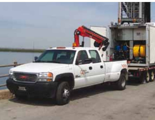
Camion-grue remorquant l'unité mobile
