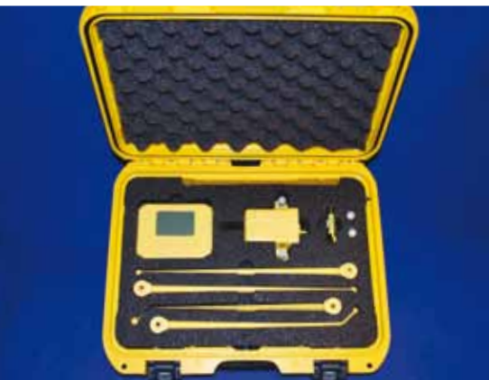
Le détecteur d'isolateurs fissurés (DIF)
