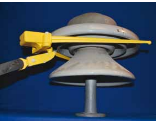
La sonde munie des palpeurs pour isolateurs de 120 KV contre la jupe d'un isolateur
