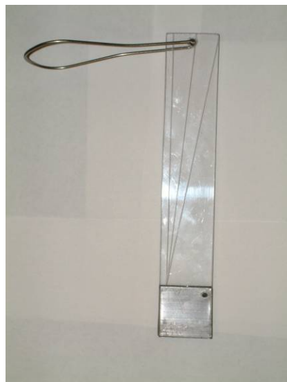
Figure 19 - Appareil de mesure de l'inclinaison
