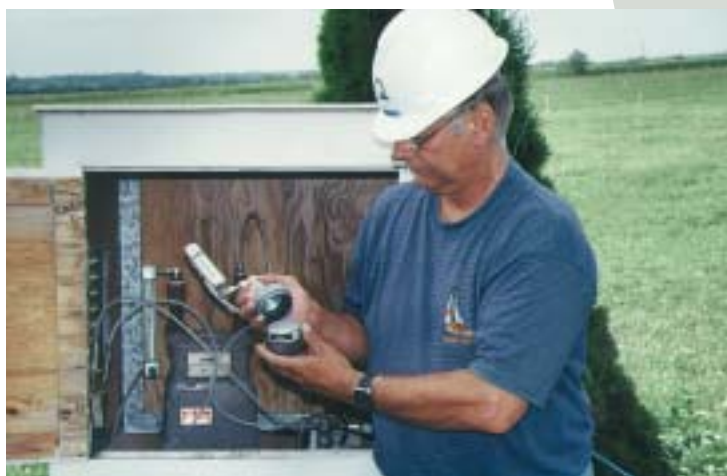
Des postes de contrôle radiologique équipés de différents appareils de mesure sont installés autour de la centrale afin de détecter la présence éventuelle de matières radioactives.
