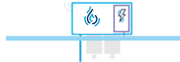
Unité de toit hybride (thermopompe air/air + brûleur au gaz naturel)
