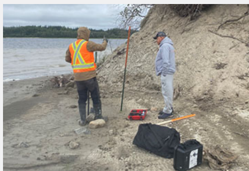
Alexandre Paradis (Avizo) et John Sam (terrain de piégeage CH33) se préparent à effectuer le levé à une station de contrôle en aval de La Grande-1 lors d'une étude de terrain de la dynamique des berges, le 30 juillet.
