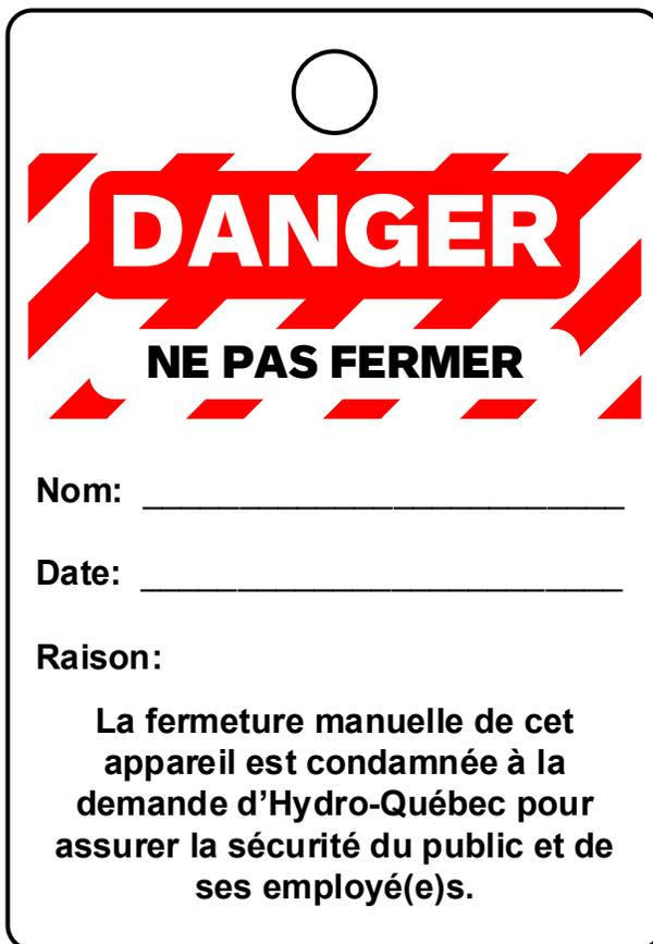
Figure 2 : Étiquette de cadenassage de la fermeture manuelle du disjoncteur principal de l'IPE
